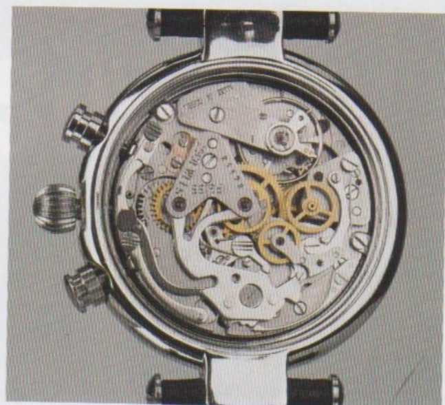
Das Werk der Poljot Basilika ist bis auf die Stoßsicherung mit dem alten Schweizer Valjoux-Chronographenwerk Kaliber 7734 identisch.
